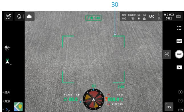
30. 变焦框：切换广角相机为主画面时，变焦框显示变焦相机的视场范围和倍率。
