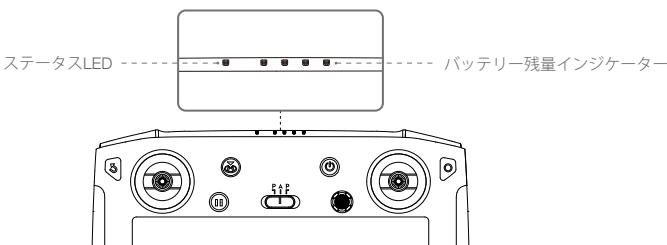
バッテリー残量インジケーターは送信機の電池残量を表示します。ステータス LED は、リンクの状態や、操作スティック、バッテリー残量低下、および高温に関する警告を表示します。
