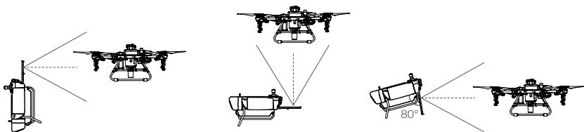
機体が最適な伝送範囲から出ないようにしてください。信号が弱い場合は、アンテナを調整するか、機体をより近い範囲で飛ばしてください。
