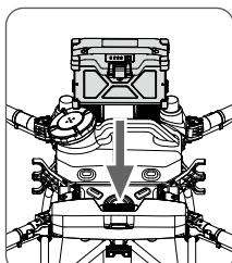
カチッという音がするまで、インテリジェント ライトバッテリーを機体に挿入します。
