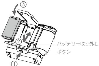
💡 インテリジェント バッテリーを取り外すには、バッテリー解除ボタンを押したままバッテリーを押し下げます。
