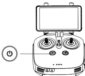
遥控器内置备用电池，以支持外置智能电池的热插拔功能。用户在开机情况下取下外置智能电池（此时显示设备会熄屏以节电），并在 3 分钟内重新安装电量充足的智能电池，则可保证遥控器始终不断电。
