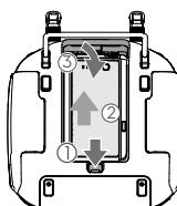
**💡** 如需取下智能电池，请打开仓盖，按住电池解锁按钮，然后向下推动智能电池将其取出。
