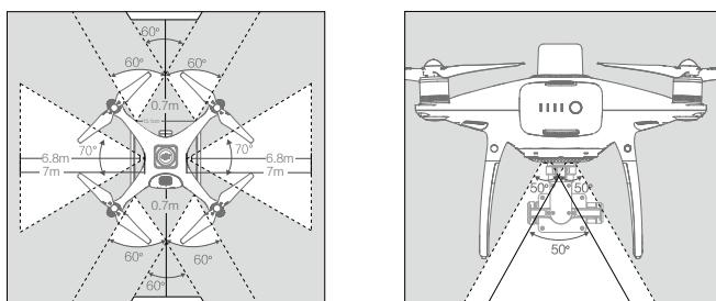
**⚠ 在 P 模式下，当飞行速度小于 6 m/s 时，前后视觉系统均有效；而当飞行速度大于 6 m/s 时，仅朝向飞行器前进方向的视觉系统工作，请谨慎飞行。**
