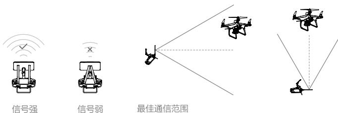
操控飞行器时，务必使飞行器处于最佳通信范围内。及时调整操控者与飞行器之间的方位与距离，或天线位置以确保飞行器总是位于最佳通信范围内。
