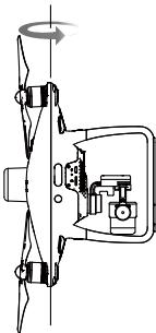
4. 完成校准，若飞行器状态指示灯显示红灯闪烁，表示校准失败，请重新校准指南针。
