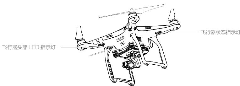
飞行器头部 LED 指示灯用于指示飞行器的机头方向，在电机启动后将会显示红灯常亮。尾部的飞行器状态指示灯指示当前飞控系统的状态。请参考下表了解不同的闪灯方式所表示的飞控系统状态。
