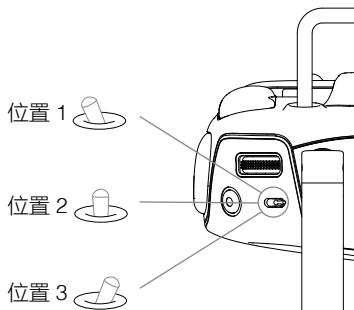
P 模式 ( 定位 )：使用 GPS 模块或视觉定位系统以实现飞行器精确悬停。根据 GPS 信号接收强弱状况，P 模式在以下三种状态中动态切换：
