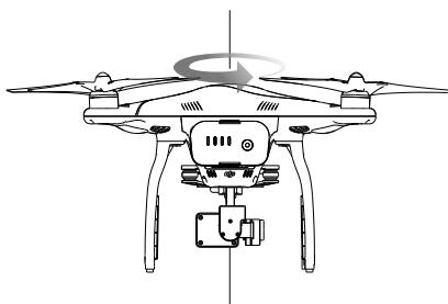
3. 使飞行器机头朝下，水平旋转 360 度。
