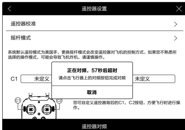
4. 使用合适工具按下对频按键 (如下图所示) 后松开, 完成对频。对频完成后, 遥控器指示灯显示绿灯常亮。
