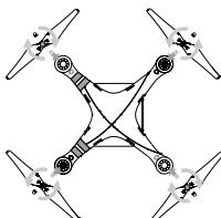
⚠ 确保螺旋桨安装正确；手动拧紧每只螺旋桨，确保螺旋桨都安装稳固。
