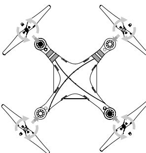
⚠ 请确保黑色和银色的螺旋桨安装位置正确。若安装错误飞行器将不能正常飞行。
