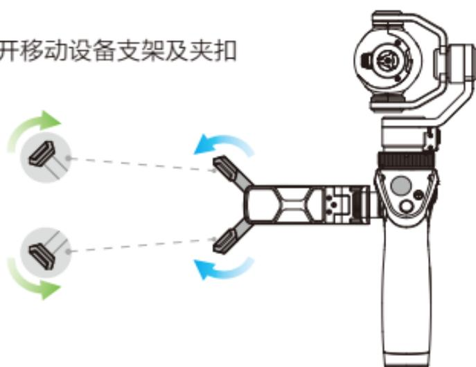
将移动设备一端置于支架夹扣中，
