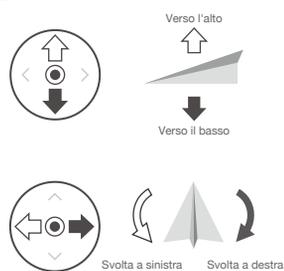
Il dispositivo di controllo remoto è impostato sulla modalità 2 in modo predefinito.
