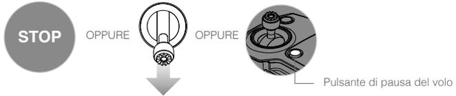
Il velivolo si ferma e rimane sospeso in posizione dopo essere uscito dalla modalità TapFly. Toccare una nuova direzione di destinazione per continuare a volare o iniziare il volo manualmente.
