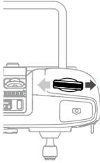
오른쪽 다이얼은 짐벌 팬을 제어합니다. 다이얼을 오른쪽으로 돌리면 짐벌이 시계 방향으로 이동합니다. 다이얼을 왼쪽으로 돌리면 짐벌이 반시계 방향으로 이동합니다. 다이얼이 정지하면 카메라는 현재 위치를 유지합니다.
