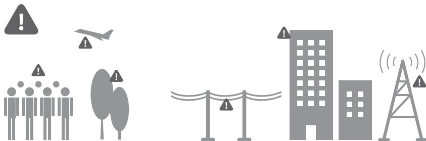
Vermeiden Sie es, über oder in der Nähe von Menschenmengen, Bäumen oder Flughäfen zu fliegen. Starke elektromagnetische Störungen, wie z. B. Stromleitungen, Basisstationen und hohe Gebäude können den Kompass an Bord beeinträchtigen. Beobachten Sie während des Flugs immer die Umgebung.
