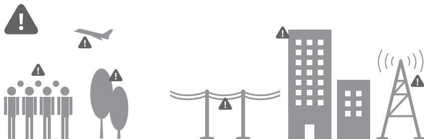
Évitez de voler au-dessus ou près des foules, des arbres ou des aéroports. Des sources électromagnétiques puissantes telles que les lignes à haute tension, les stations de base et les grands immeubles peuvent affecter le compas embarqué de l'appareil. Pilotez toujours l'appareil en observant votre environnement avec attention.
