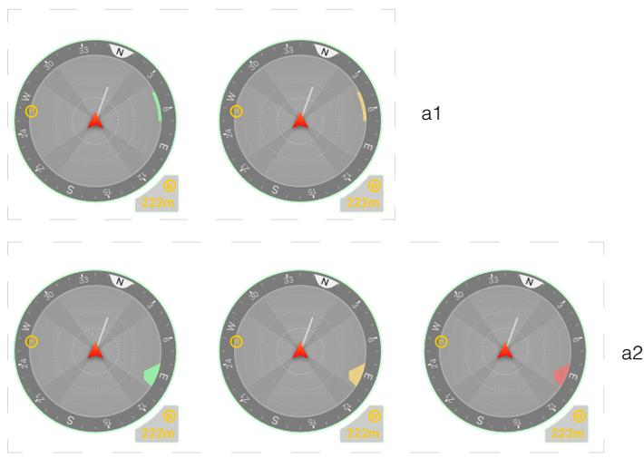
浅色为飞行器可避障的区域，深色为避障盲区，在飞行过程中请避免飞行器的速度矢量线（即飞行器旁边的白线）落入避障盲区中。水平方向上：
