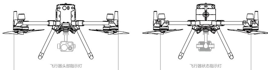
1. 飞行器头部指示灯：用于指示飞行器的机头方向。
