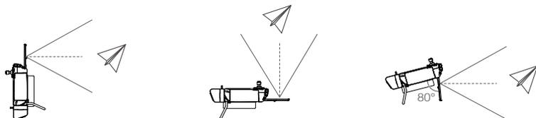
获取最佳通信范围，遥控器与飞行器的相对位置如图所示，当天线与遥控器背面呈  $80^\circ$  或  $180^\circ$  夹角时，且天线平面正对飞行器，可让遥控器与飞行器的信号质量达到最佳状态。
