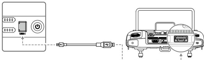
3. 开启遥控器电源，确保遥控器接入互联网。
