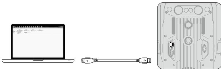
⚠ 校准过程切勿关闭电源或断开 USB-C 线。
