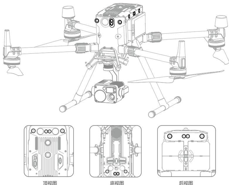
视觉系统位于飞行器机身的前后左右、顶部以及底部，由摄像头组成。红外感知系统位于飞行器机身的前后左右、顶部以及底部，由红外测距传感器组成。
