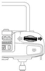
右拨轮用于控制云台平移角度。顺时针拨动拨轮，云台顺时针转动。逆时针拨动拨轮，云台逆时针转动。
