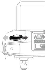
左拨轮用于控制云台俯仰角度。顺时针拨动拨轮，云台向上转动。逆时针拨动拨轮，云台向下转动。
