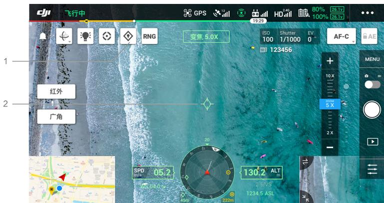
1. 在地图界面上，点击可在地图中央打一个点。该点高度为当前飞行器飞行高度。
