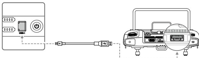
1. 连接电池箱至交流电源，开启电池箱电源按键，使用 USB-C 线连接固件升级接口至遥控器。
