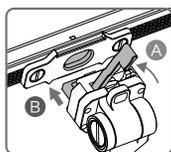
打开遥控器上的安装支架锁扣，安装移动设备支架到遥控器
