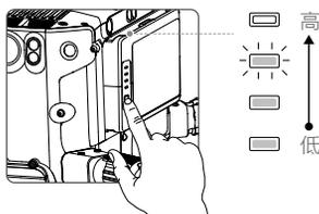
电量指示灯可用于显示电池放电过程中的电池电量，指示灯定义如下。
