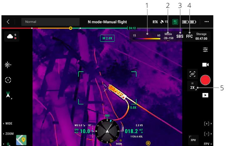
1. Palette/Isotherme : affiche les valeurs de mesure de température les plus élevées et les plus basses de la vue actuelle. Appuyez pour choisir entre différentes palettes de mesure de la température infrarouge, ou activez l'isotherme pour définir les intervalles de mesure de la température. Veuillez noter que si la zone mesurée dépasse les valeurs de mesure de température maximale ou minimale de la vue actuelle, le réglage ne prendra pas effet.
