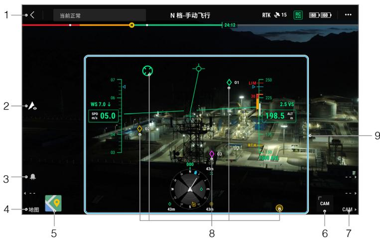
1. 顶部状态栏：顶部状态栏将显示飞行器状态、挡位、信号质量等信息。详细内容请阅读顶部状态栏章节。
