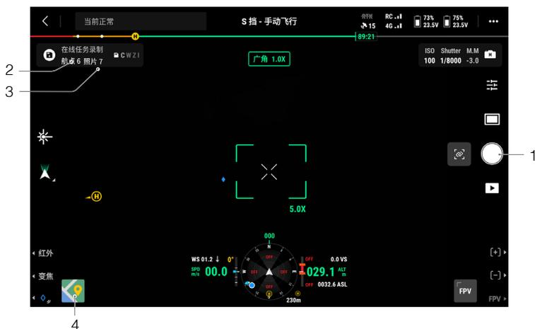
1. 控制云台、调整变焦倍数对准目标后，点击该按键触发拍照，或者按下遥控器 C1 按键创建航点；航点数量和照片数量会增加，并相互对应。
