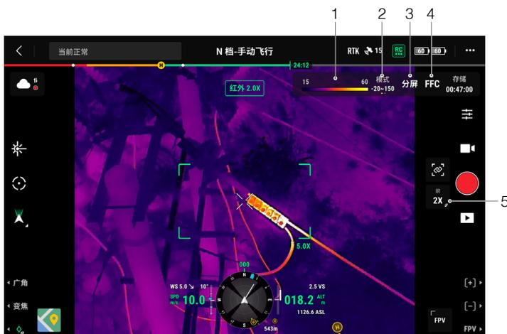
1. 调色盘：显示当前画面测温最高值和最低值，点击后可以选择不同的红外测温调色盘；也可打开等温线功能，设置测温区间（需注意，测温区域若超过当前画面测温的最高值或最低值，将不会生效）。
