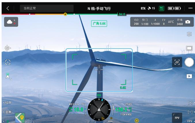
变焦框：切换广角相机为主画面时，变焦框显示变焦相机的视场范围和倍率。
