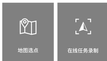
航点航线的规划方式包含地图选点和在线任务录制两种。地图选点可通过在地图界面中添加并编辑航点以生成航线。在线任务录制则在飞行过程中记录飞行器打点位置、拍照等信息以自动生成航线。
