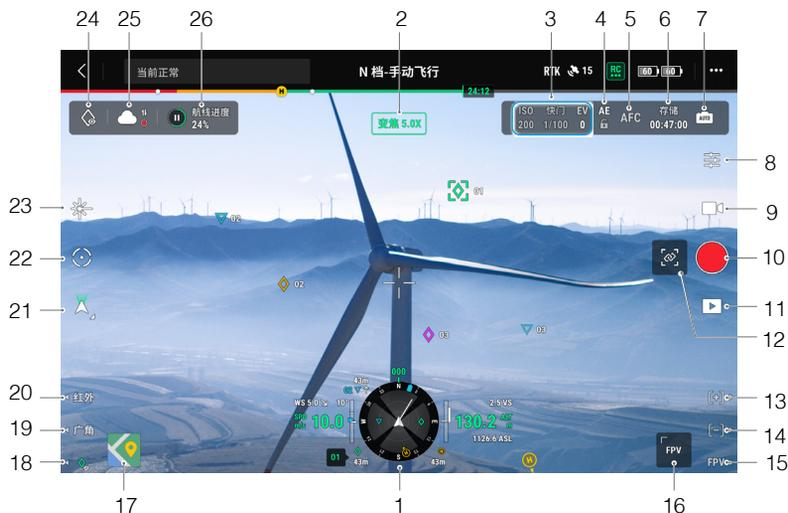
1. 导航信息模块：具体内容请阅读导航信息模块章节；需注意，相机界面中，导航信息模块的左侧将显示水平速度、风速、云台的俯仰角度和俯仰刻度信息，实时显示云台相对地平面倾角，且当云台处于  $-90^\circ$ 、 $0^\circ$ 、 $-45^\circ$  等关键刻度时，数字将高亮显示；导航信息模块右侧显示海拔高度信息、相对高度信息、垂直避障信息和垂直速度条。
