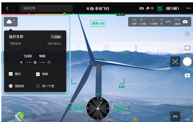
26. 航线任务控制 / 状态显示: 航线执行过程中, 可以在相机界面查看执行进度。点击暂停 / 继续按钮, 暂停 / 恢复航线任务; 点击该面板, 可查看航线名称和航线动作等。
