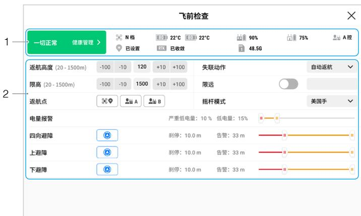
1. 查看飞行器的健康信息、飞行档位、智能飞行电池电量、遥控器角色、遥控器内置电池和内置电池电量、返航点状态、RTK 状态以及相机 microSD 卡存储信息。
