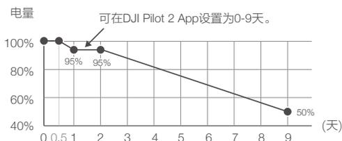
2. 合适的存储电量可以延长电池使用寿命，建议使用电池箱的存储模式将电池充至 50% 进行存储，电量低于 50% 时最大存储天数可参考下表。
