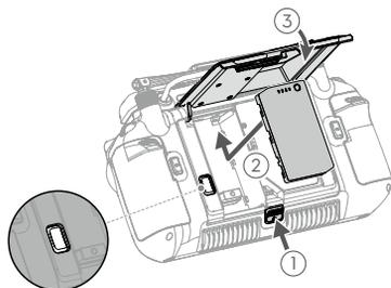
1. 将后盖开启按键往里推到底，打开后盖。
