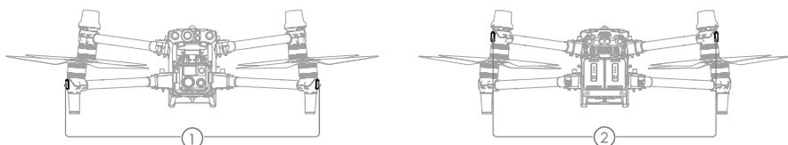
1. 机头指示灯：用于指示飞行器的机头方向，为红绿灯交替闪烁。
