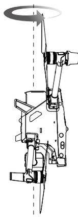
4. 完成校准，若飞行器机尾指示灯显示红灯闪烁，表示校准失败，请重新校准指南针。
