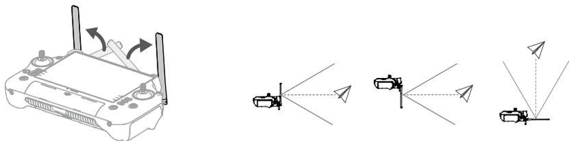
根据遥控器与飞行器的相对位置，调整遥控器外置天线指向并将天线平面对准飞行器方向，以便遥控器与飞行器的信号质量达到最佳状态。
