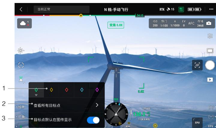
1. 长按遥控器 L3 按键，可调出 Pin 点的设置面板，Pin 点有五种颜色可选择，可根据用户场景和定义，按照不同类型的目标点进行颜色设置。
