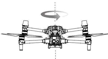
3. 使飞行器机头朝下，水平旋转 360°。
