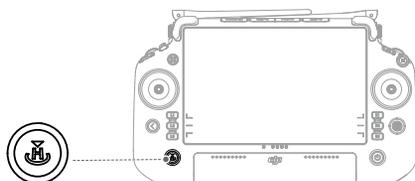
⚠ 在高级双控模式下，无飞行控制权的遥控器无法使用按键触发和停止返航。
