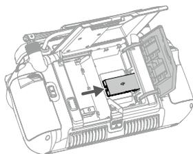
1. 将后盖开启按键往里推到底，打开后盖；移除螺丝并打开网卡仓盖。
