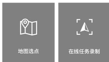
航点飞行的规划方式包含地图选点和在线任务录制两种。**地图选点**可通过在地图界面中添加并编辑航点以生成航线。**在线任务录制**则在飞行过程中记录飞行器打点位置、拍照等信息以自动生成航线。
