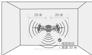
⚠ 一旦视觉系统关闭或者受遮挡不能正常工作，飞行器将无法在室内低空定高悬停，且降落速度保护将无法正常运行（高速着陆可能导致飞行器受损，请注意着陆速度）。
