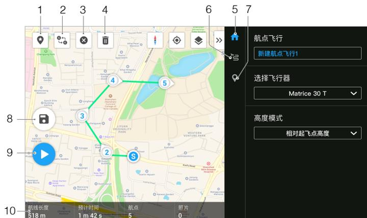
1. 兴趣点 (POI)：点击开启兴趣点功能，地图上将自动添加一个兴趣点，拖动可调整位置。添加兴趣点后，可在设置飞行器偏航角时选择朝向兴趣点，则执行航线任务时飞行器机头将始终朝向兴趣点。再次点击此图标，可关闭兴趣点功能。
