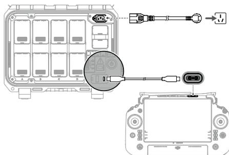
1. 使用 AC 线连接 BS30 智能电池箱的电源接口至交流电源。
