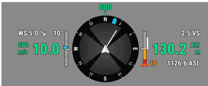
水平避障信息：浅色为飞行器可避障的区域，深色为避障盲区，飞行时请避免飞行器的水平速度矢量线落入避障盲区中。
