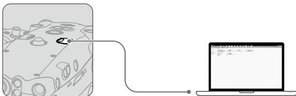
⚠ 校准完毕后需要等待计算校准数据，请勿关机或拔除连接线。
