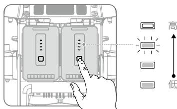
电量指示灯可用于显示电池放电过程中的电池电量，指示灯定义如下。
