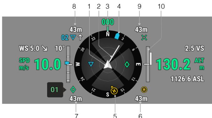
导航信息模块仅在相机界面中显示左右两侧的速度、高度等信息；在飞行界面中，两侧信息以飞行辅助功能的形式进行展现。
