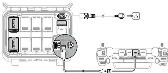
1. 插入多颗 TB30 智能飞行电池，开启电池箱电源。
