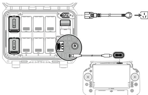
1. 使用 AC 线连接电池箱电源接口至交流电源。
