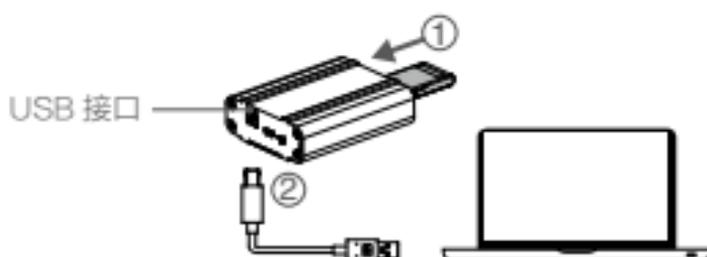
3. 连接成功后，电脑将会显示磁盘 DJI\_AXXX。打开磁盘，进行数据导出。
