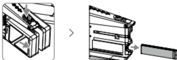
2. Inserte el CINESSD en la Estación DJI CINESSD y conecte la Estación a un ordenador mediante un cable USB.
