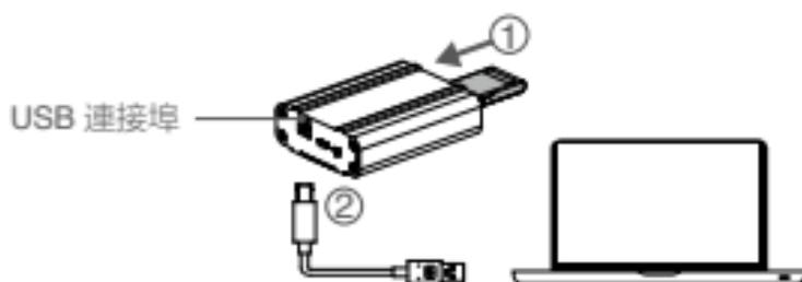
3. 連接成功後，電腦將會顯示磁碟 DJI\_AXXX。開啟磁碟，進行資料導出。
