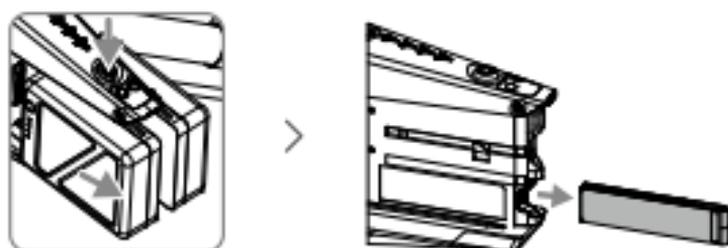
2. Вставьте CINESSD в считывающее устройство DJI CINESSD. Подключите его к компьютеру с помощью входящего в комплект кабеля USB.
