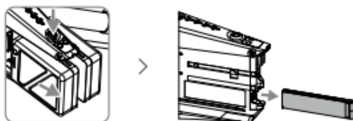
2. 将存储卡插入 DJI CINESSD 读卡器中（注意确保插入到位），通过 USB 数据线连接到电脑上。
