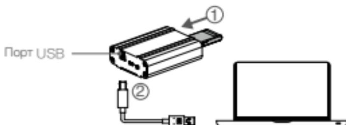
3. Когда соединение будет установлено, отобразится значок считывающего устройства с именем DJI\_AXXX. Нажмите, чтобы начать экспорт файлов.
