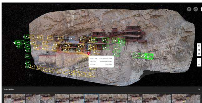
4. 预览图片中的黄色十字表示模型上的点在照片中的位置。点击图片，则其对应的相机位置显示变为蓝线，双击图片可查看大图及缩放。
