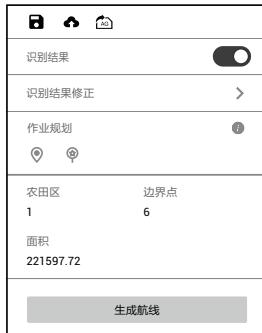
1. 开启“识别结果”，则地图上将显示软件对农田、果树、建筑、地面、水面、电线杆等不同区域的识别结果。
