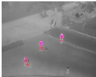
等温线提供搜人、搜火、自定义三种设置。当选择搜人或搜火时，等温线两个阈值的温度为固定值，拍摄画面将根据温度值将人物或火焰着重显示出来。
