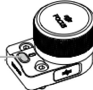
2. Калибровку объективов без механического ограничения необходимо выполнять вручную. Нажмите два раза на многофункциональную кнопку кольца фокусировки, чтобы начать калибровку.
