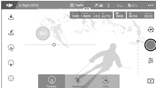
3. Toque el objetivo y espere a que aparezca "VUELA". Toque "VUELA" para confirmar la selección y la aeronave volará automáticamente hacia el objetivo. Aparecerá un mensaje si no se puede alcanzar el objetivo. En ese caso, seleccione otro objetivo y vuelva a intentarlo. Puede cambiar el objetivo durante el vuelo tocando la pantalla.
