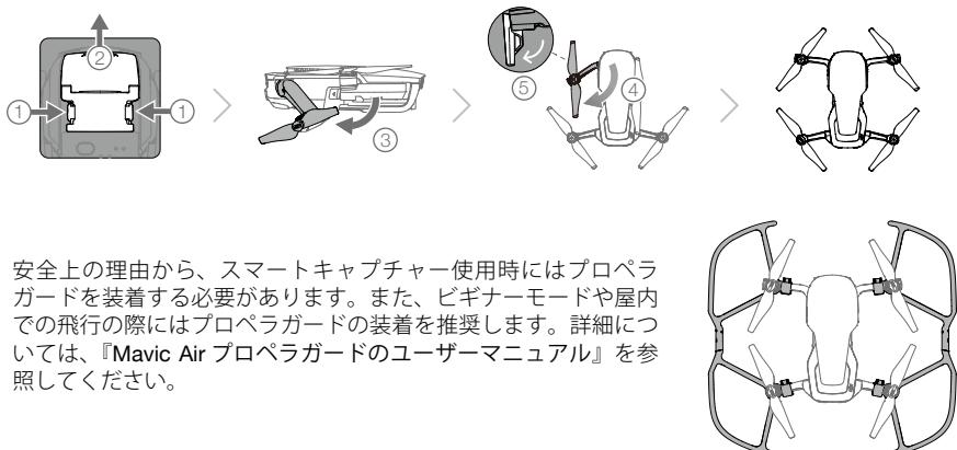
3. 安全上の理由から、スマートキャプチャー使用時にはプロペラガードを装着する必要があります。また、ビギナーモードや屋内での飛行の際にはプロペラガードの装着を推奨します。詳細については、『Mavic Air プロペラガードのユーザーマニュアル』を参照してください。
