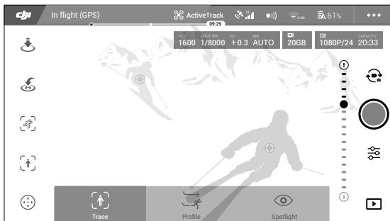
4. 機体は飛行経路上の障害物を自動的に回避します。移動速度が速すぎる、あるいは見えにくいなどの理由で機体が追尾対象を見失った場合は、対象を選択し直して追尾を再開します。
