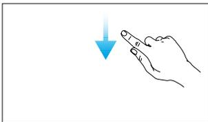
Deslize para baixo a partir da parte superior do ecrã para abrir a barra de estado quando estiver no DJI Pilot 2. A barra de estado apresenta informações como a hora, o sinal Wi-Fi e o nível de bateria do telecomando.
