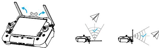
Ajuste a direção das antenas RC externas do controlador remoto e certifique-se de que o seu lado plano está voltado para a aeronave, para que o controlador e a aeronave estejam dentro da zona de transmissão ideal.
