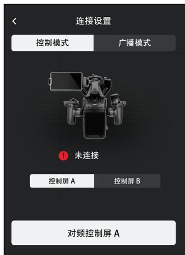
2. 在 Ronin 4D 的机身高亮监视器菜单中选择图传设置 > 配对，或长按图传发射器上的对频按键以进入对频状态，此时图传发射器上对频状态指示灯红绿交替闪烁。
