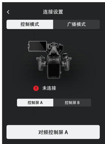
2. 在 Ronin 4D 的機身高亮度監視器選單中選擇影像傳輸設定 > 配對，或長按影像傳輸發射器上的配對按鍵以進入配對狀態，此時影像傳輸發射器上的配對狀態指示燈將紅綠交替閃爍。
