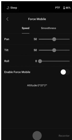
Force Mobile zahtijeva držač telefona i mobitel vertikalno montiran na stativ ili upravljač. Nakon omogućavanja ove značajke u aplikaciji Ronin, kretanjem gimbal-a može se upravljati naginjanjem i rotiranjem vašeg mobilnog telefona.
