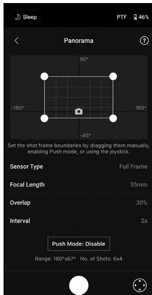
Panorama omogućuje korisnicima snimanje niza međusobno povezanih nepomičnih slika s preciznom kontrolom na temelju tipa senzora, žarišne duljine objektiva, preklapanja i intervala.
