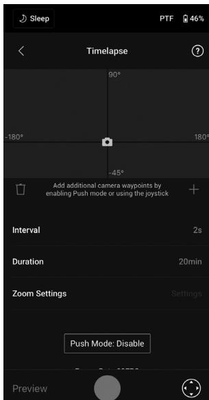
U načinu Timelapse DJI RS 3 aktivira kameru za snimanje fotografija s podešenim vremenskim intervalom i automatski se zaustavlja po završetku. Trajanje načina Timelapse i brzina slika mogu se postaviti tako da DJI RS 3 može izračunati točan broj potrebnih slika.
