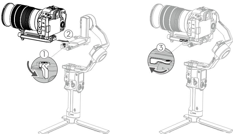
Za skidanje donje ploče za brzo otpuštanje, prebacite ručicu na potpornoj ploči kamere u otključani položaj i uklonite donju ploču za brzo otpuštanje pritiskom sigurnosne brave na montažnoj ploči.
