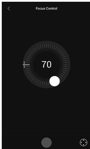
Povucite bijelu točku kako biste kontrolirali fokus nakon postavljanja DJI RS motora za fokusiranje. 0-100 označava A i B krajnje točke motora za fokusiranje. Dodirnite gumb za snimanje za početak/zaustavljanje snimanja. Dodirnite ikonu Virtual Joystick za upravljanje kretnjama gimbal-a.
