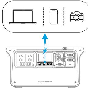
Schließen Sie das externe Gerät an einen USB-A- oder USB-C-Anschluss an, um eine Stromversorgung herzustellen.
