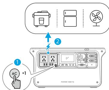
Schließen Sie das externe Gerät an den Wechselstrom-Ausgang an und drücken Sie die Wechselstrom-Taste für die Wechselstromversorgung. Die Powerstation piept einmal und die Wechselstrom-Taste blinkt langsam.
