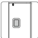
Za uključivanje ili isključivanje pritisnite i držite gumb napajanja jednu sekundu.\*
