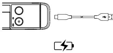
Za punjenje uređaja DJI Pocket 2, priključite USB adapter (nije priložen) na USB-C priključak pomoću isporučenog strujnog kabela. Baterija je potpuno napunjena kad se statusno LED svjetlo isključi. Razina napunjenosti baterije prikazuje se na zaslunu osjetljivom na dodir nakon uključivanja uređaja DJI Pocket 2.
