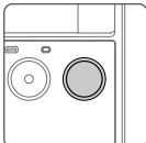
U prikazu kamere pritisnite jednom za prebacivanje između Video i Foto načina rada. Pritisnite dvaput za recentriranje gimbla. Pritisnite tri puta da biste prebacili kameru prema naprijed i prema natrag. Pritisnite i držite za potpuno zaključavanje gimbla, a za to vrijeme orijentacija kamere neće slijediti rotaciju ručke. Ovaj način rada se preporučuje za scenarije u kojima se subjekt kreće u ravnoj liniji i bez naglih pokreta.
