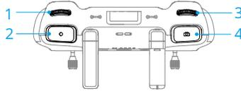
1. **Dial del estabilizador:** controla la inclinación del estabilizador.
