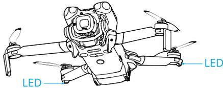
Si la aeronave está encendida pero los motores no están funcionando, los indicadores de estado de la aeronave muestran el estado actual de la aeronave.
