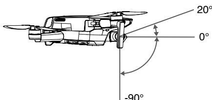
Pro ovládání náklonu kamery použijte ovládací kolečko gimbalu na dálkovém ovladači. Případně přejděte na obrazovku kamery v aplikaci DJI Fly. Držte prst na obrazovce, dokud se neobjeví kroužek. Posunutím kroužku nahoru či dolů nastavíte náklon kamery.
