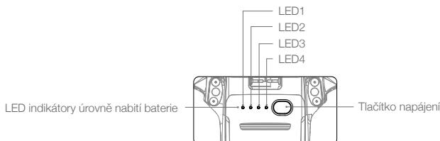
Indikátory úrovně nabití baterie zobrazují úroveň nabití letové baterie během nabíjení a vybíjení. Stavy indikátorů úrovně nabití baterie jsou následující:
