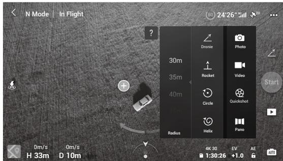
3. Pilih mode pengambilan gambar dan target Anda dalam tampilan kamera dengan mengetuk lingkaran pada subjek atau menyeret kotak di sekitar subjek, kemudian ketuk Mulai untuk mulai mengambil gambar. Pesawat akan kembali ke posisi semula setelah pengambilan gambar selesai.
