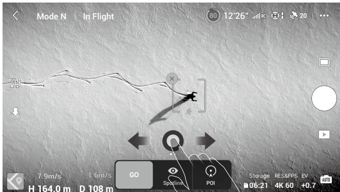
3. Dalam Jejak di ActiveTrack, arah penjejakan boleh ditukar menggunakan roda arah. Roda arah akan diminimumkan jika tiada operasi untuk tempoh yang lama atau manapun kawasan lain skrin tidak diketik. Jejak atau Selari boleh dipilih selepas roda arah diminimumkan. Penjejakan akan ditetapkan semula ke belakang selepas Jejak dipilih semula.
