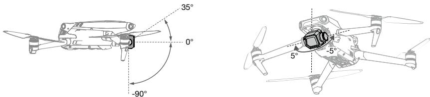
Gunakan dail gimbal pada alat kawalan jauh untuk mengawal kecondongan kamera. Sebagai alternatif, masuk ke paparan kamera di DJI Fly. Tekan skrin sehingga bar pelarasan kamera muncul. Seret bar ke atas atau ke bawah untuk mengawal kecondongan dan ke kiri atau ke kanan untuk mengawal pendar.
