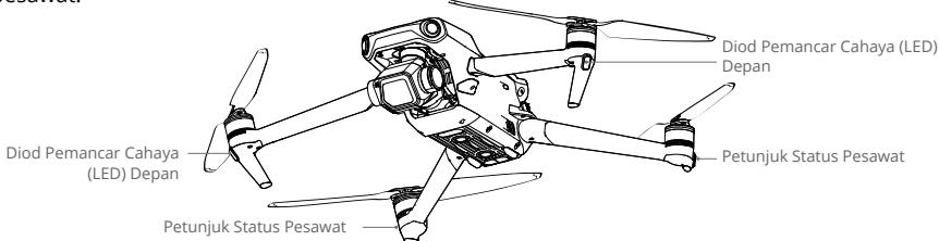
Semasa pesawat dihidupkan tetapi motor tidak berfungsi, LED hadapan menyala merah padu untuk menunjukkan orientasi pesawat.
