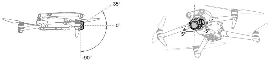
Koristite gimbalni kotačić na daljinskom upravljaču za kontrolu nagiba fotoaparata. Alternativno, upišite prikaz kamere u programu DJI Fly. Pritisnite zaslon dok se ne pojavi traka za podešavanje kamere. Povucite traku prema gore ili dolje za upravljanje nagibom i lijevo ili desno za kontroliranje pomicanja.
