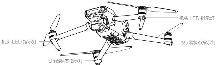
机头 LED 指示灯用于指示飞行器的机头方向，飞行器开启且电机未启动时将显示红灯常亮。
