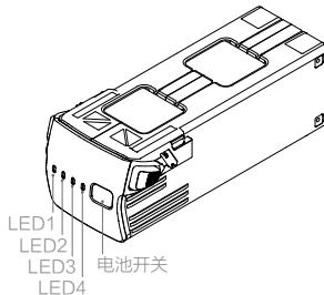
电量指示灯可用于显示智能飞行电池充放电过程中的电量，指示灯定义如下。
