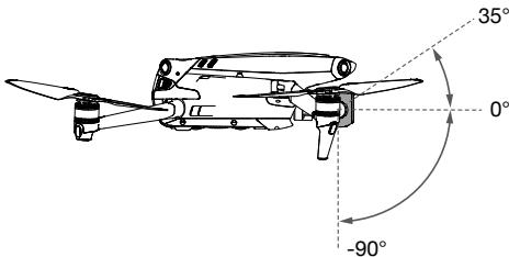
通过遥控器的云台俯仰控制拨轮和 DJI Fly App 可调整俯仰角度。在 DJI Fly App 相机界面长按屏幕直至出现云台角度控制条，通过上、下拖曳控制条可调整云台俯仰角度。
