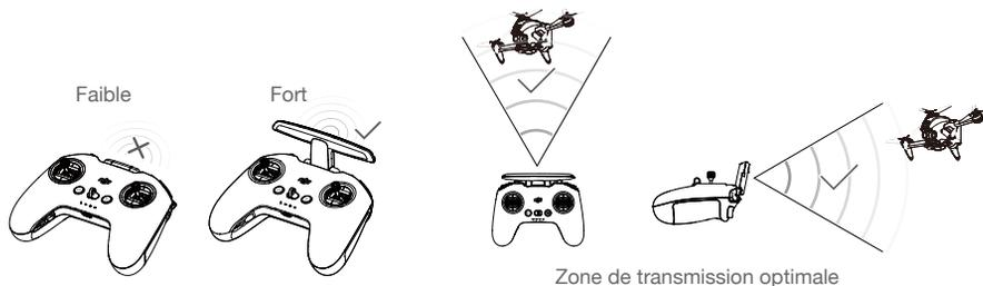
⚠ N'utilisez PAS d'autres appareils sans fil de la même bande de fréquences afin d'éviter toute interférence avec la radiocommande.
