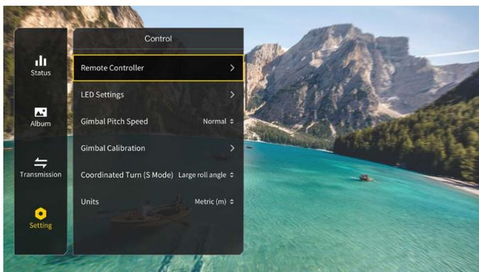
Les fonctions de certains boutons de la radiocommande peuvent être personnalisées dans Radiocommande. Il s'agit notamment du bouton C1, du commutateur C2 et du mode personnalisé sur le bouton de mode de vol. Le mode de joystick peut être réglé et l'exponentielle peut être ajustée lors de l'utilisation du mode Manuel. Les utilisateurs peuvent également atténuer la radiocommande.
