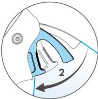
当按压油门扳机进入第二段位置时，可以控制飞行器向飞行眼镜界面中圆圈的位置前进。
