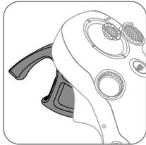
油门扳机的按压幅度有两段。轻按到一段与二段分界位置时，可以感觉到有明显停顿。按压油门扳机到不同的位置，可以控制飞行器的不同动作。
