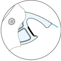
当油门扳机处于完全放松状态下，飞行器处于悬停状态。
