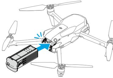
Pressione as fivelas da bateria para remover a bateria do compartimento.
