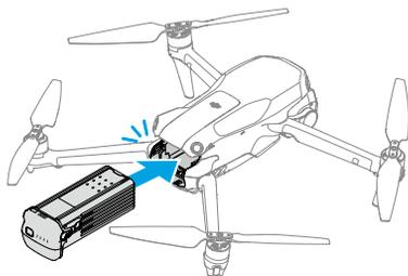
バッテリーバックルを押して、バッテリーを収納部から取り外します。
