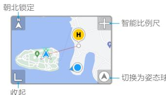
**朝北锁定** 将地图锁定为北面朝上显示。点击后可切换为根据遥控器实时朝向显示，即地图跟随遥控器朝向改变而旋转。
