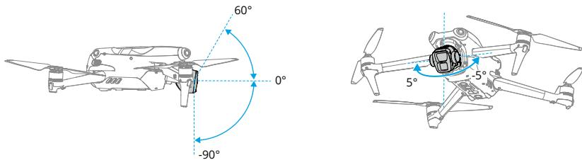
通过遥控器的云台俯仰控制拨轮和 DJI Fly App 可调整俯仰角度。在 DJI Fly App 相机界面长按屏幕直至出现云台角度控制条，通过上下或左右拖曳屏幕可调整云台俯仰、平移角度。
